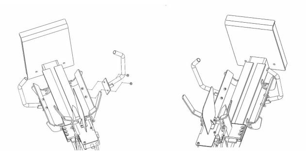
Instale los dos soportes laterales con los tornillos M8 y las tuercas M8.
